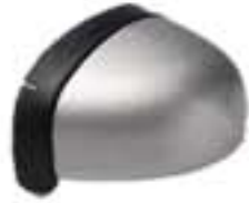
ZEHENKAPPE: AUS ALUMINIUM, WEITE 11, 200 JOULE
